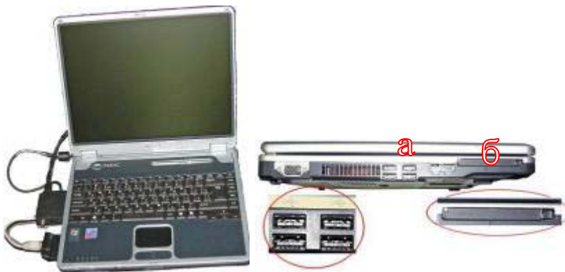
Вид сбоку слева Разъемы для подключения а. для USB адаптера б. для карты PCMCIA
