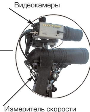
Аппаратно-программный комплекс «ПОТОК-Д» размещается на базе легкового автомобиля. Конструктивное исполнение комплекса позволяет осуществлять его оперативную переустановку с одного автомобиля на другой.
